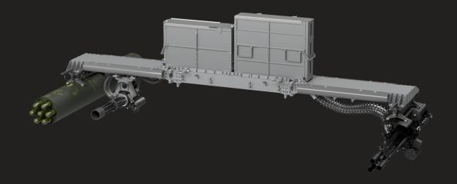
M260 ROCKET LAUNCHER, M1340 MINIGUN & TWIN HELLFIRE RAIL M260 ROCKET LAUNCHER, M134D MINIGUN & GAU-19B
