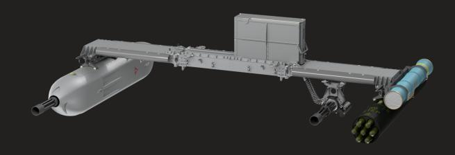
RAYTHEON GRIFFIN® B LAUNCHER, M260 ROCKET LAUNCHER,
